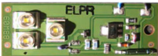
Abbildung 14: Print mit drei 1-Watt-Power-LEDs
